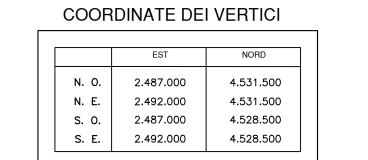
RAPPRESENTAZIONE CONFORME DI GAUSS-BOAGA QUADRO D'UNIONE
